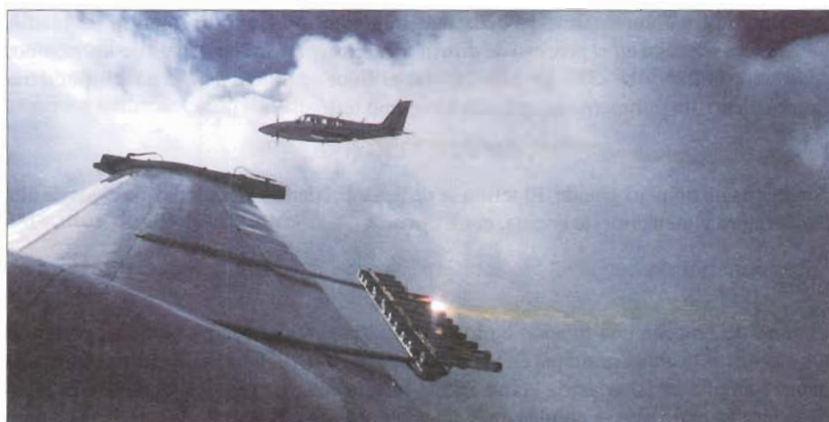
FIGURA 21.21 Siembra de nubes, utilizando partículas de AgI.
