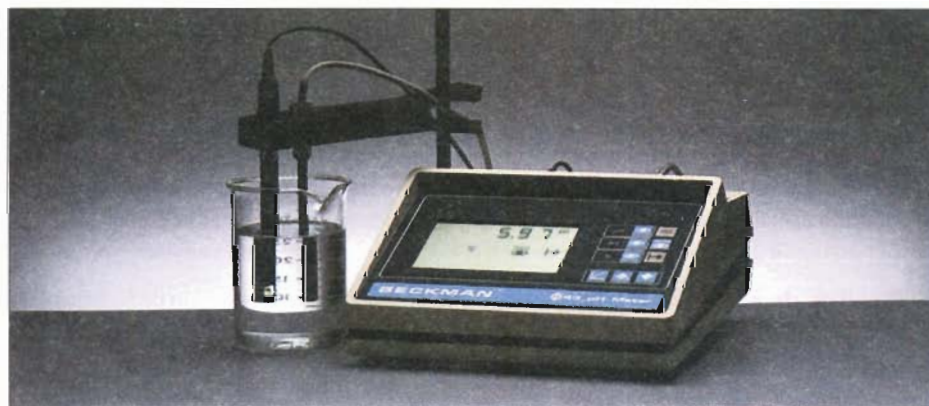
FIGURA 15.2 Un potenciómetro se utiliza en el laboratorio para determinar el pH de una disolución. Aunque muchos potenciómetros tienen escalas con valores que van desde 1 hasta 14, los valores de pH en ocasiones son menores que 1 o mayores que 14.
