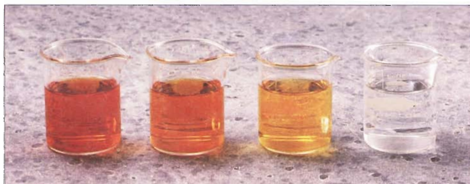
FIGURA 13.3 La disminución en la concentración de bromo puede observarse como pérdida de color, a medida que el tiempo transcurre (de izquierda a derecha).
