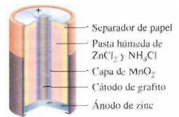
FIGURA 19.7 Sección interior de una celda seca como las que se utilizan en las lámparas y en los radios de transistores. En realidad, la celda no está completamente seca, ya que contiene una pasta electrolítica húmeda. El ánodo y el cátodo están aislados entre sí.
