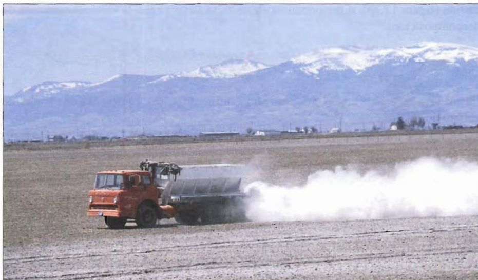
FIGURA 17.24 Diseminación de óxido de calcio (CaO) en un suelo acidificado. A este proceso se le denomina alcalizado.
